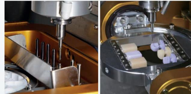
材料に応じて、ATC機能(オートツールチェンジ)により7本のバーを自動的にチェンジ。交換の手間を省き、時間のロスも削減。生産性もよりアップします。
