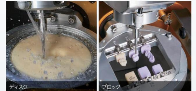
一台で、湿式(ウェット)・乾式(ドライ)の2つの加工方式を兼用できます。さらにブロックとディスクに対応し、様々な材料を選択できます。1台の設備投資でご希望の加工環境を実現させます。
